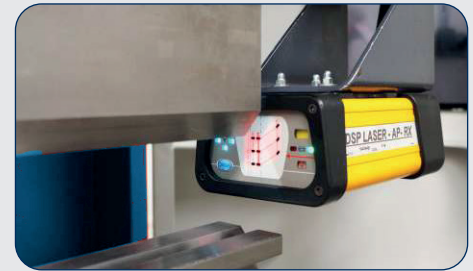
System bezpieczeństwa Przedni laserowy system ochrony palców ze sterownikiem bezpieczeństwa PLC
